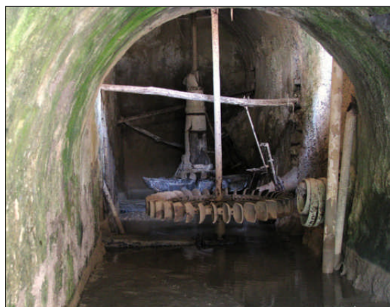
L'interno del mulino ristrutturato e il canale di alimentazione con le due ruote di comando delle macine
