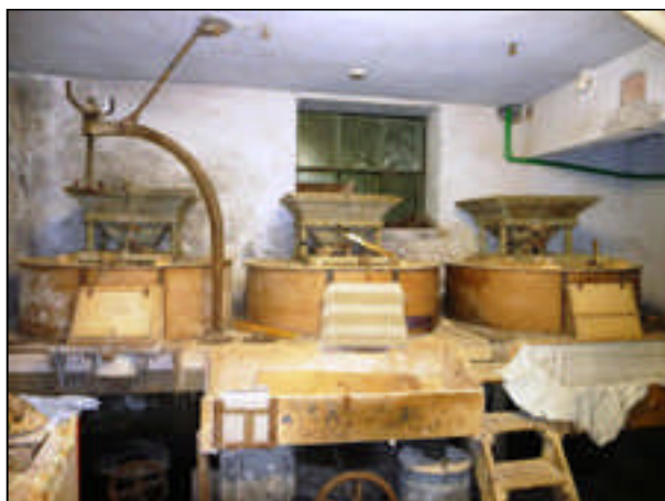
Le tre macine originali adatte per tutti i tipi di granaglie, mentre la macina per le castagne, funzionante con motore elettrico, si trova in un piccolo locale a parte.
