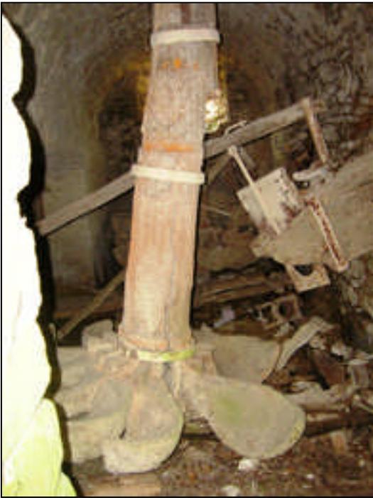
*Una delle pale in legno e relativi cucchiai dell'antico mulino. Si noti anche la paratoia per la regolazione della portata dell'acqua.*
